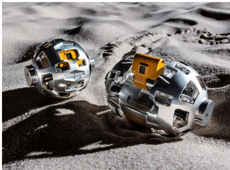
展開前(左)・展開後(右)の変形型月面ロボット「LEV-2」(SORA-Q) (撮影場所: JAXA 相模原キャンパス宇宙探査実験棟宇宙探査フィールド)
